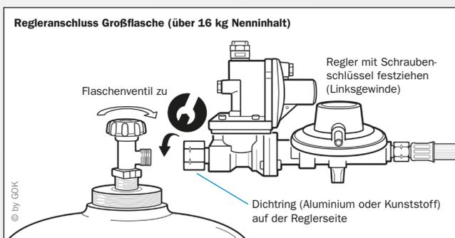
Bei Flaschenwechsel den Regleranschluss erst dann lösen, wenn das Flaschenventil vollständig (im Uhrzeigersinn) zuge dreht ist. Der Druckregler muss gut dichtend angeschlossen werden. Auf vorhandenen Dichtring achten (siehe Skizze). Achtung Linksgewinde! Nach jedem Flaschenwechsel muss die Dichtheit des Regleranschlusses mit schaubildenden Mitteln (z. B. Seifenwasser) geprüft werden.
